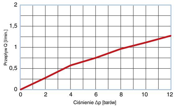
CHECK VALVE® Krzywa przepływu – screened BFAA055014; T = 50 °C, olej hydrauliczny HLP46
