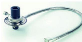
Imagen 4: Medidor del ángulo de giro para el procedimiento del ángulo de giro
