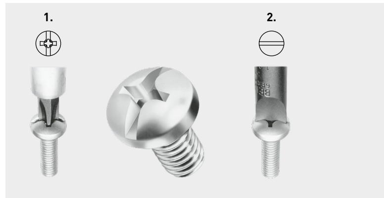
Fig. 9: Vite a testa cilindrica bombata «Freedriv» con intaglio ed impronta a croce Phillips forma H
