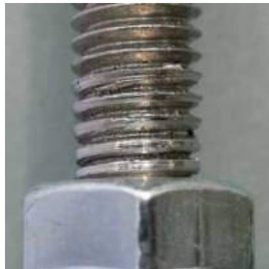
Figure 1: Elemento di collegamento grippato
