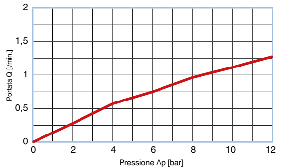
CHECK VALVE® Curva di portata – screened BFAA055014; T = 50 °C, olio idraulico HLP46
