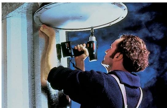
Le viti con ottagono incassato possono essere avvitate impiegando un normale inserto quadro commerciale. Grazie alla conicità dell'impronta, è impossibile perdere la vite una volta posizionata sull'inserto dell'avvitatore (inserti quadri 1/4" BN 10318).
