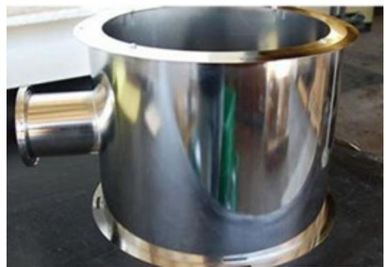
Figure 2: surface après passivation et polissage
