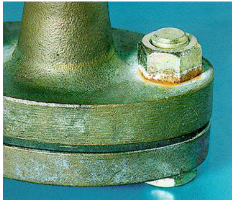
Un écrou plaqué en zinc sur une bride en bronze
