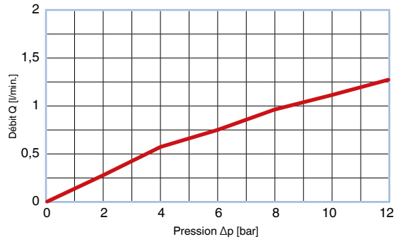
CHECK VALVE® Courbe de flux – screened BFAA055014; T = 50 °C, huile hydraulique HLP46
