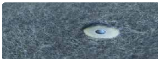
La tecnología MM-W permite la integración de elementos funcionales opcionales en el piso del maletero, por ejemplo, para correas de sujeción o amarre.
