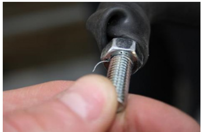
Fig. 2: Rebaba en el hilo de la rosca
