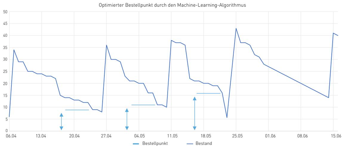
Mit SmartOrdering: Automatische Anpassung des Bestellpunktes durch Reevaluierung und Anpassung des Bedarfs durch den Algorithmus.
