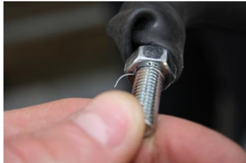
Obr. 2: Otřepy na závitech
