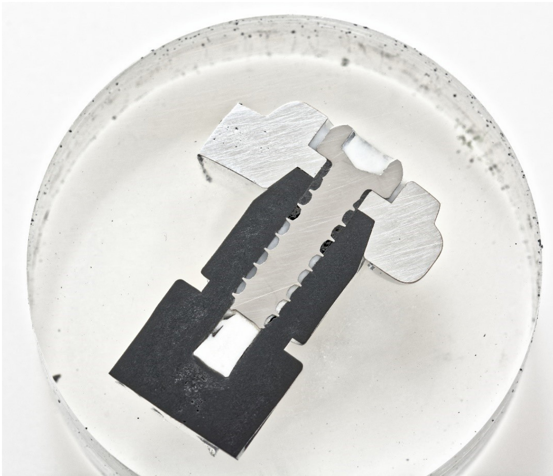
Přímé zašroubování do polymeru
