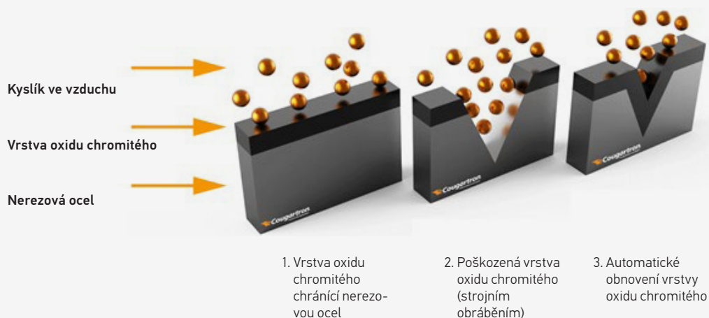
Obrázek 3: Ukázka formování vrstvy oxidu chromitého
