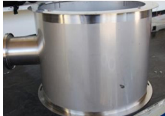
Obrázek 1: Povrch před pasivací
