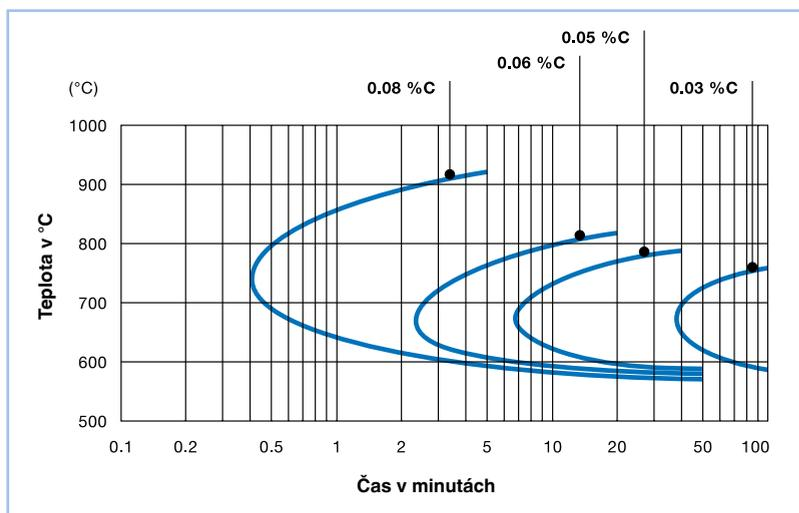
Existuje-li riziko mezikystalické koroze, doporučují se následující třídy oceli:
