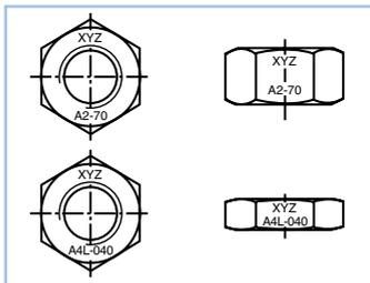
Pokud matice třídy oceli A2 a A4 jsou označeny drážkami a třída pevnosti není uvedena, potom se použije třída pevnosti 50/025.
