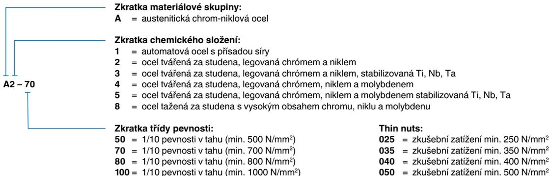
**Šrouby se sníženou únosností** kvůli geometrii hlavy nebo dřívku, které mohou být podrobeny zkoušce tahem, jsou nyní označeny třídou pevnosti dodatečným číslem 0. Například **050, 070, 080, 0100**.
