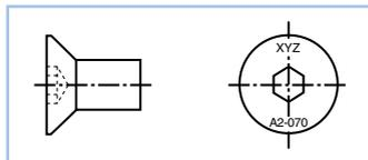
Šrouby, které nesplňují požadavky na pevnost v tahu a pevnost v křutu kvůli jejich geometrii, a které nemohou být podrobeny tahové zkoušce kvůli jejich krátké délce, mohou být označeny **bez uvedení třídy pevnosti**.
