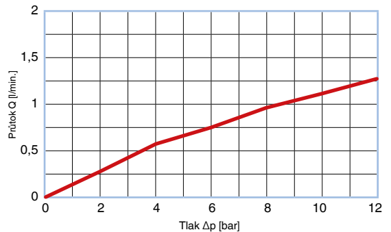
CHECK VALVE® Křivky průtoku – screened BFAA055014; T = 50 °C, hydraulický olej HLP46
