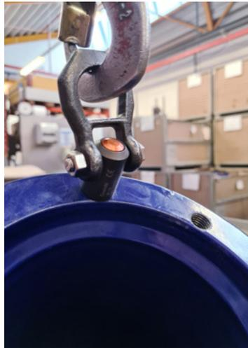
Il perno può essere inserito in un foro filettato delle parti inferiori interne in ghisa degli idranti, premendo un pulsante.
