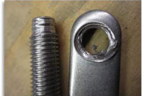
Lorsque deux fixations sont accouplées, il se produit une pression entre les surfaces filetées du boulon et de l'écrou et la couche d'oxyde de protection peut se casser. La forte friction entre les interfaces des fixations d'union, où le métal de base a été exposé (à cause de la couche d'oxyde rognée), peut provoquer un blocage des surfaces, ce phénomène étant connu comme grippage. Plus le coefficient de friction est élevé, plus le risque de grippage augmente.
