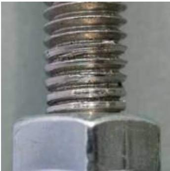
Le grippage est la friction ou l'abrasion des filetages, dans lesquels soit les éléments du joint coïncent pendant le montage soit les filetages sont endommagés. Il est aussi appelé soudure à froid locale (liaison par surface) des flancs des filetages. Il se forme généralement lorsque les flancs du filetage frottent l'un contre l'autre pendant une période de temps prolongée.
