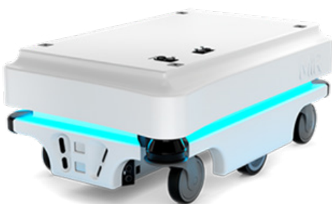
Un robot de transport MiR 100
