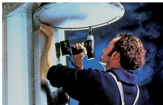
L'entraînement à huit pans creux enfichable est à mettre en oeuvre avec les embouts carrés courants dans le commerce. Grâce à la forme d'entraînement conique de l'embout, la vis reste enfichée solidement dans l'outil (embout carré 1/4" BN 10318)
