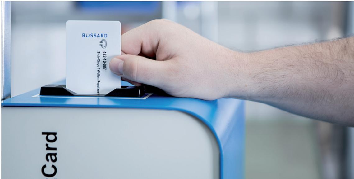
Bossard SmartCard réunit le système de carte kanban classique et la technologie RFID. Ce système peut être intégré facilement à n'importe quel procédé de production.
