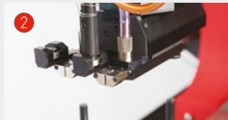
INSTALLATION AUTOMATIQUE D'UN NOUVEL OUTIL SUPÉRIEUR
