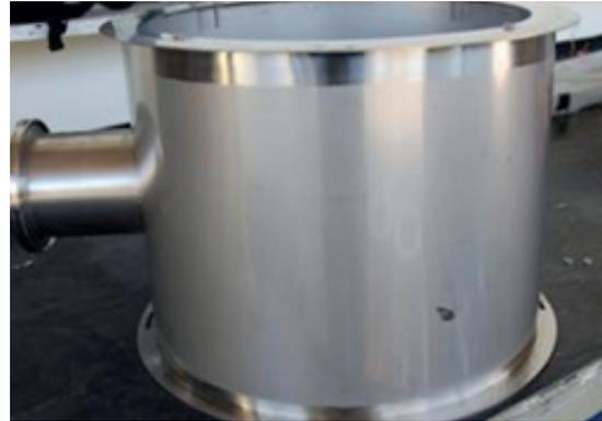
Abb. 1: Oberfläche vor Passivierung
