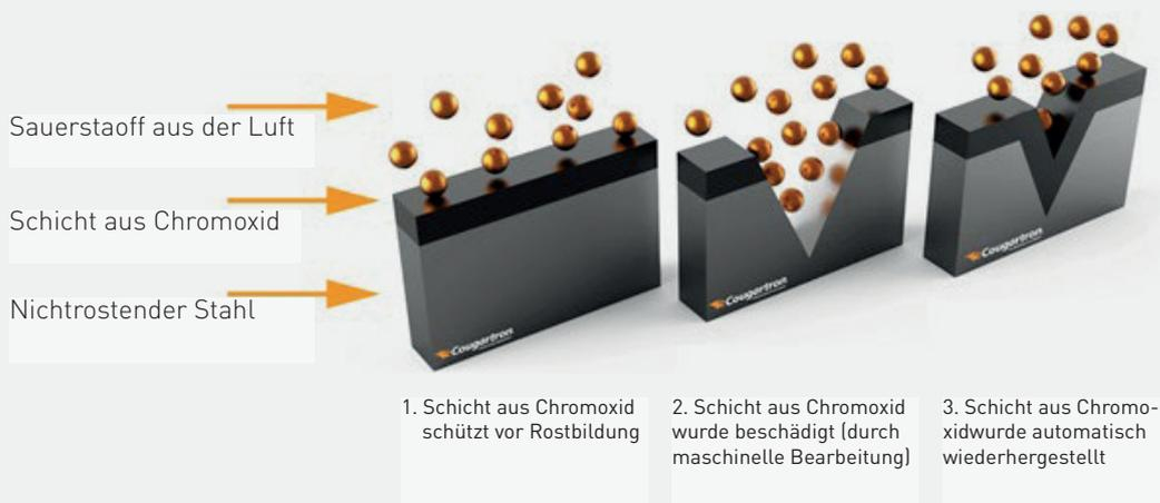
Abb. 3: Zeigt den Prozess, wie eine Schicht aus Chromoxid gebildet wird
