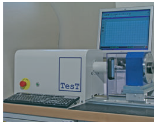
Im täglichen Einsatz bei Bossard: Der neue Prüfstand für die Reibwertprüfung
