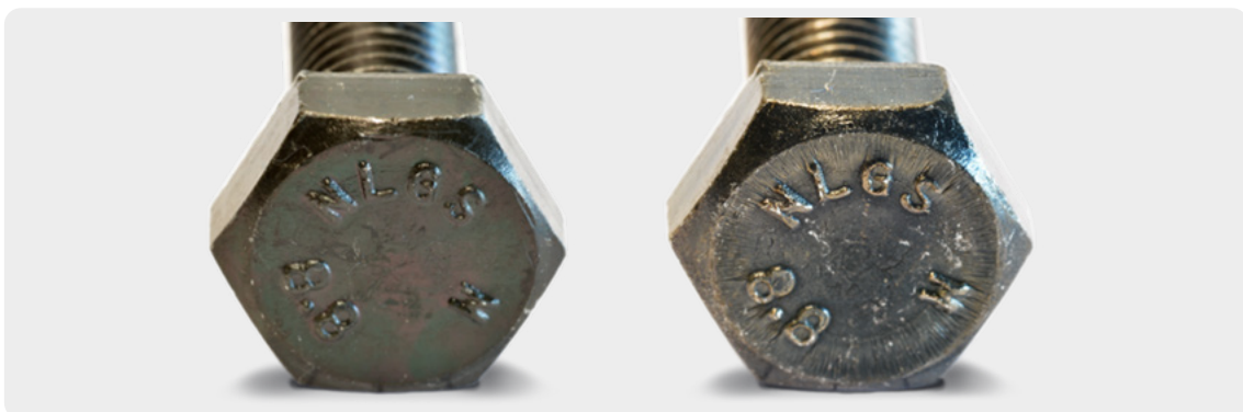
Im Vergleich: Links verzinkt schwarz chromatiert Cr(VI)-haltig, rechts verzinkt schwarz passiviert Cr(VI)-frei.
