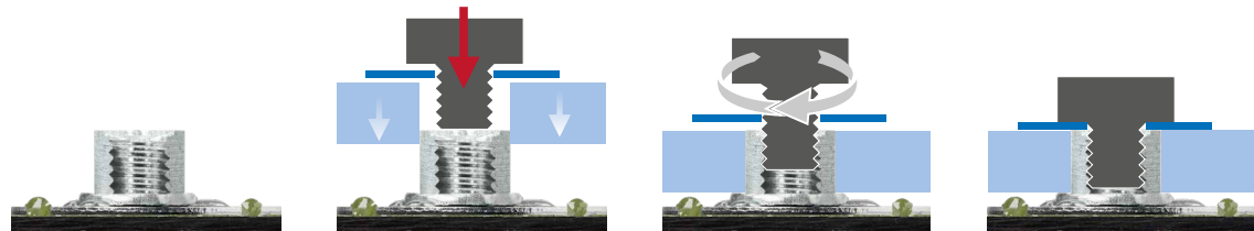
Aufgeklebt: Buchse aufgeklebt auf dem Trägermaterial
