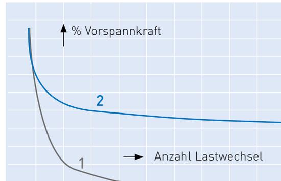
Vorspannkraft bei Dauerbelastung
