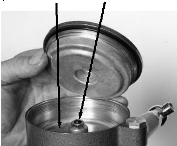
**12.** A l'aide d'une paire de tenailles de blocage serrées sur l'écrou **61**, tirer sur l'ensemble piston à air pour le sortir du cylindre.
