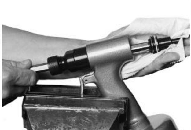
6. Les joints toriques et/ou les bagues d'appui endommagés peuvent alors être remplacés.
