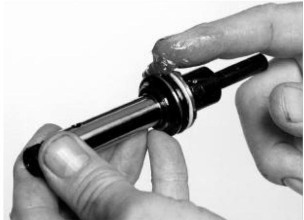
3. Positionner le piston à l'intérieur de l'ensemble tête en le poussant légèrement à l'arrière.
