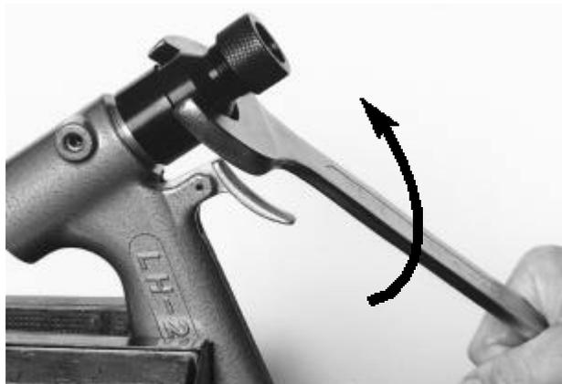
8. Renverser l'outil afin de permettre à l'huile hydraulique restante de s'écouler dans un conteneur adéquat.
