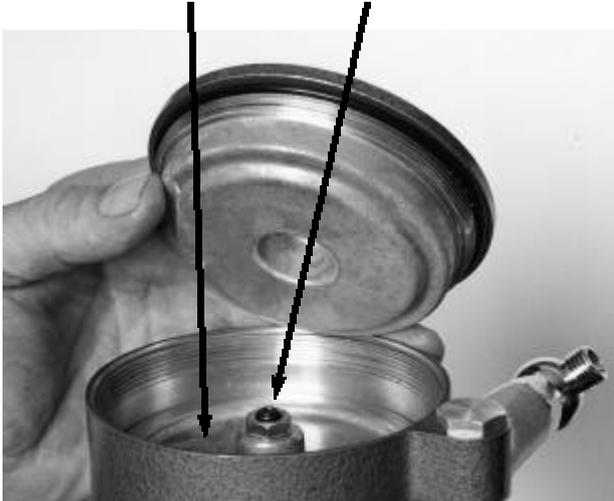
2. A l'aide d'une paire de tenailles de blocage serrées sur l'écrou **61**, tirer sur l'ensemble piston à air pour le sortir du cylindre à air.
