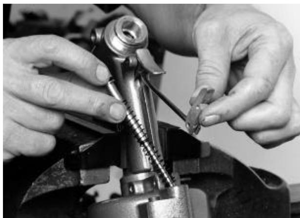
**11.** Serrer fermement l'outil renversé dans un étau (avec mâchoires en fibres). Utiliser une clé à douille de 28 mm pour dévisser la coiffe de cylindre **51** dans le sens anti-horaire de manière à exposer le piston à air **58** & l'écrou **61**.
