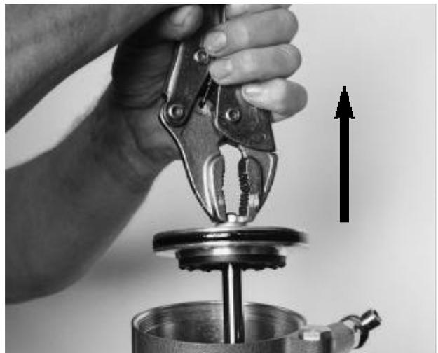
3. Remplir l'ensemble poignée de l'outil avec de l'huile hydraulique pour transmission automatique (AFT). Continuer de remplir jusqu'à ce que le liquide soit au niveau du bas du chanfrein du petit **cylindre hydraulique** dans le col de l'outil. Utiliser un conteneur propre afin d'éviter toute contamination du liquide hydraulique.
