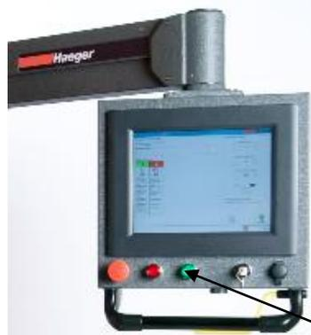
3. Appuyez sur l'interrupteur de mise en marche de la machine
