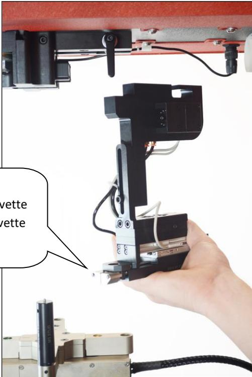
**Étape 2 :** Insérez la navette multiple dans le support de verrouillage positif.
