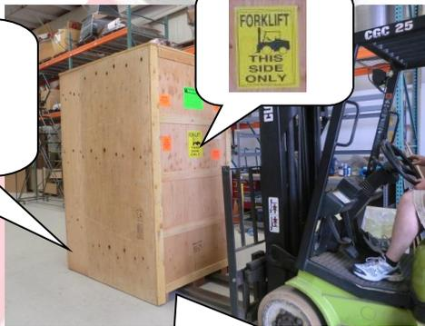
Positionnez **!** **TOUJOURS** le chariot élévateur à l'**arrière** de la machine.
