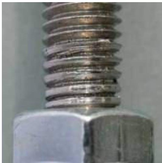
Fig. 1 : fixation grippée
