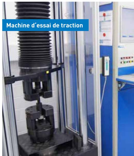
Machine d'essai de traction
