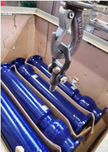
Grâce à la manille mobile, la broche de levage peut être facilement accrochée au crochet de la grue.
