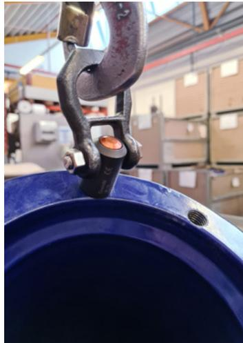
Par simple pression d'un bouton, la broche de levage s'insère dans le filetage de la pièce en fonte.
