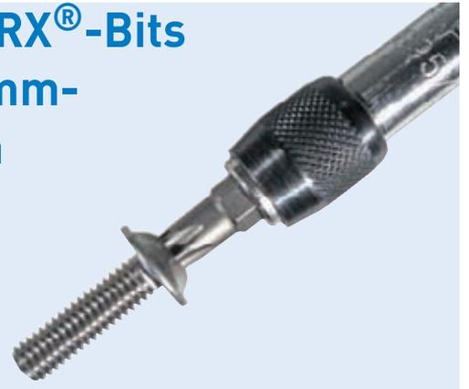
Die neuen TORX®-Bits mit Klemmfunktion vereinen die Vorteile der bisherigen TORX®-Bits mit dem Vorteil, dass das Verbindungselement auf dem Bit aufgesteckt werden kann. Besonders interessant wird dieser Vorteil bei der Montage von rostbeständigen Verbindungselementen, bei denen ein Einsatz eines Magnethalters wirkungslos ist.
