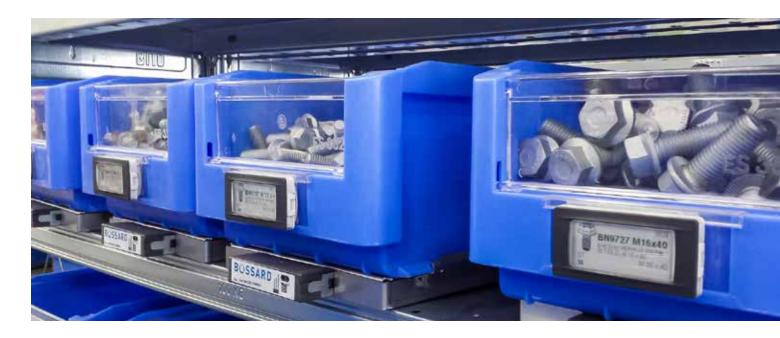
Stromversorgung kann «Smart-Bin Flex» flexibel in bestehende Montageplätze eingefügt werden. Sind aufgrund von Veränderungen im Produktionslayout Umplatzierungen von Boxen notwendig, können diese schnell und problemlos umgesetzt werden.
