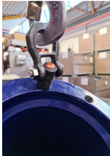
Per Knopfdruck lässt sich der Gewindetragebolzen ins Gewinde des Gusseisen Rohlings einführen.
