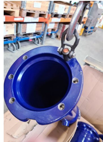
Der Rohling kann locker und ohne grössere Anstrengungen mit dem Kran angehoben und wunschgemäss positioniert werden.
