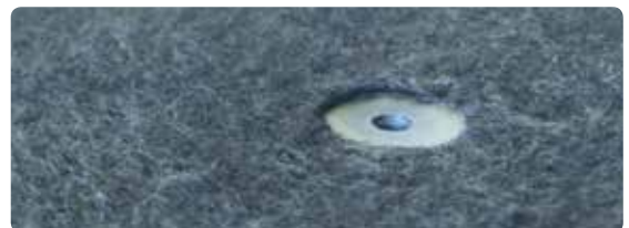
Die MM-W-Technologie ermöglicht die Integration optionaler Funktionselemente auf dem Ladeboden, etwa für Spann- oder Zurrgurte.
