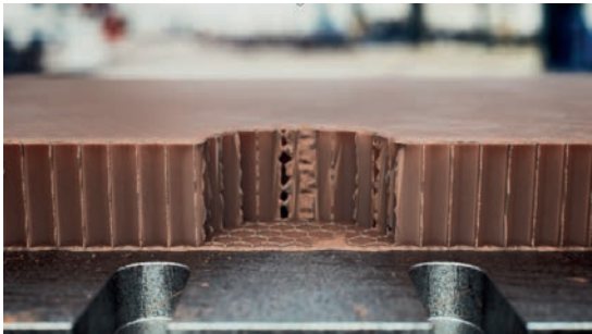
Positionieren des Trägermaterials mit der vorbereiteten Bohrung.
