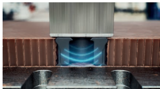
Anwenden des MM-Welding-Schweißverfahrens mit Ultraschallenergie, um das Polymer zu verflüssigen und eine Verbindung zu beiden Schichten herzustellen.
