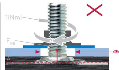
Die Bohrung in der anzubringenden Komponente (B) ist größer als 80-90% des Durchmessers der big-Head Schulter.
