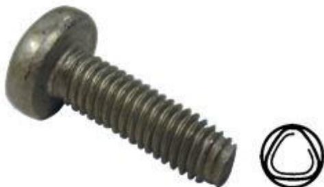
Die Schraube weist über ihre gesamte Länge den charakteristischen trilobularen Querschnitt auf. Im Gewindeabschnitt haben die Schrauben unabhängig von der Ausrichtung denselben Durchmesser am Gewindeabschnitt. Beim Gewindefurchen konzentrieren sich die Druckspannungen auf die 3 „Kanten“. Das Gegenmaterial wird dadurch einfacher verformt.
