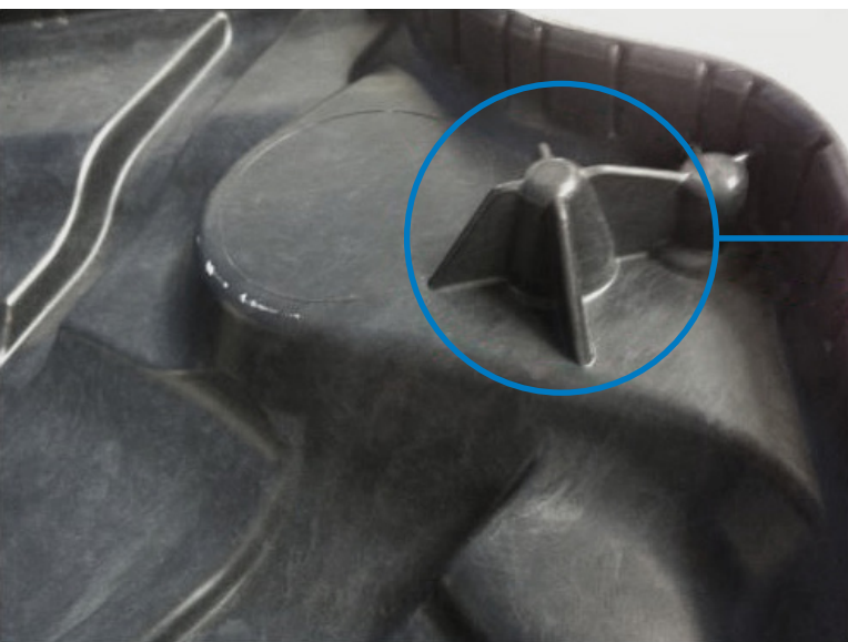
SMC-undervogn med strukturelt kompositmateriale bygget op omkring traditionel befæstelsesløsning.
