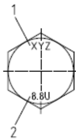
图 10：热浸镀锌螺栓和螺钉螺纹缩径处理，表面处理前公差等级 6az
