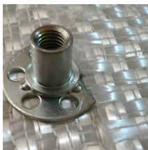
Soluzione co-pro- cesso: incorporazione in un laminato polimerico rinforzato con fibre
