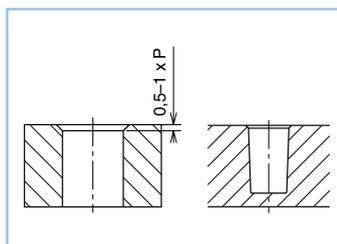
L'engagemment cylindrique a pour avantage que par l'adaptation de sa profondeur, la profondeur de vissage de différentes épaisseurs d'éléments à fixer peut rester constante. Cela signifie que pour les mêmes matériaux et dimensions de vis, le même couple de montage peut être appliqué. Aussi recommandé lors d'un moulage sous pression.
