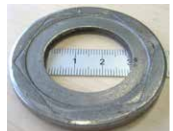
Imagen 2: Arandela en U con dureza demasiado baja. Marcada deformación plástica en la zona del apoyo de la cabecera
