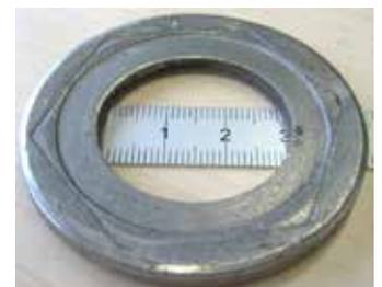
Figure 2 : Disque en U avec une dureté trop faible. Fortes déformations plastiques au niveau du repose-tête
