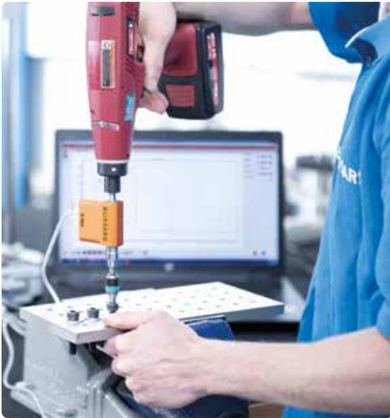
Esecuzione della misurazione della coppia di serraggio
