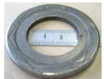
Bild 2: U-Scheibe mit zu geringer Härte. Starke plastische Verformungen im Bereich der Kopfauflage
