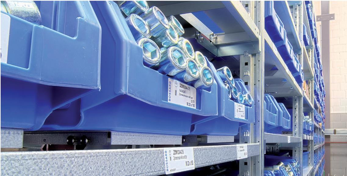
Dieses einzigartige vollautomatische System mit Sensorüberwachung ist hervorragend geeignet für Supermarkt-Bereiche und Produktionsstrassen. SmartBin bewirtschaftet alles: kleine Teile mit einem Gewicht von wenigen Gramm sowie sperrige Teile von bis zu 1000 kg pro Palette. Gewichtssensoren überwachen die Bestände laufend online. Bestellungen werden automatisch ausgelöst und stellen eine nahtlose Versorgung sicher.
