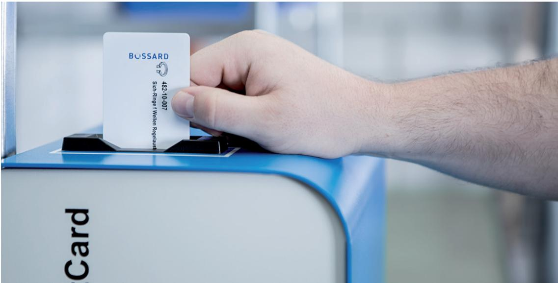
Il sistema SmartCard di Bossard nasce dall'abbinamento dell'originale sistema a schede kanban e la più recente tecnologia RFID. Il sistema può essere facilmente implementato in qualsiasi processo produttivo.
